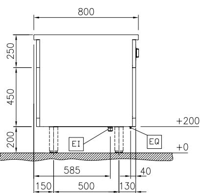
**EI** = Conexión eléctrica (energía)
